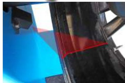
Equilibratrice **SUPER AUTOMATICA con puntatore LASER** acquisizione automatica dei parametri, riconosce il tipo di cerchio se lega o ferro, lavora su tutte le tipologie di cerchi, capacità di lavoro fino a pneumatici da 24" dotata anche di freno per bloccaggio ruota **MOD. EDWB220L**
